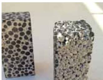
Elle entre également dans la composition de granulats d'argile expansés à haute performance pour l'industrie des bétons légers. Ils vont remplacer les granulats classiques lorsque des propriétés de légèreté, d'isolation thermique et phonique sont requises.
