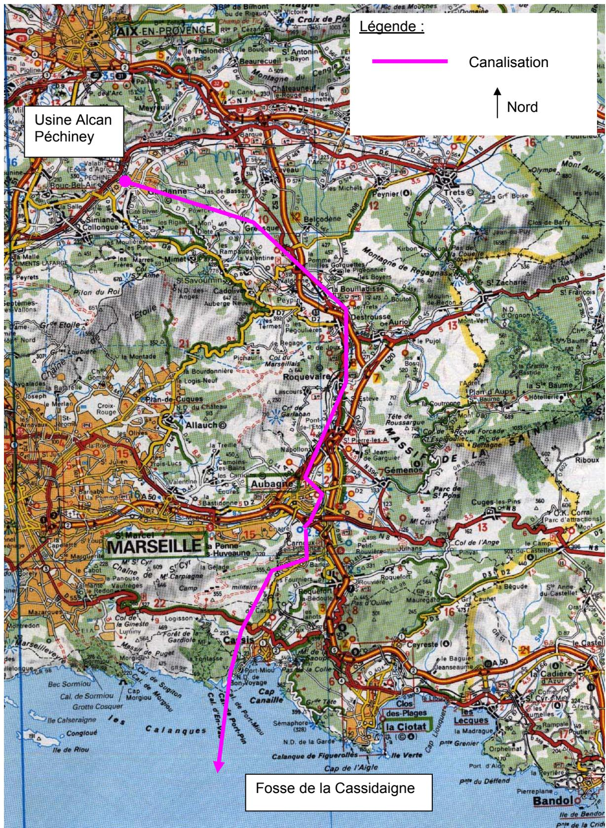
Figure 4. Tracé schématique du parcours de la canalisation de rejet en mer (échelle : 1/200 000)
